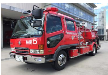
非常用消防車(タンク車)
